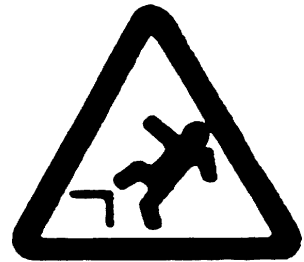
Warnung vor Absturzgefahr
