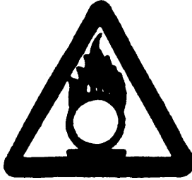
Warnung vor brandfördernden Stoffen
